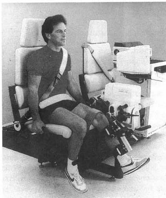
Εικ. 1. Ισοκινητικό δυναμόμετρο το οποίο χρησιμοποιείται για μυικές δοκιμασίες, προπόνηση δύναμης και κατά την αποκατάσταση μετά από κακώσεις.
